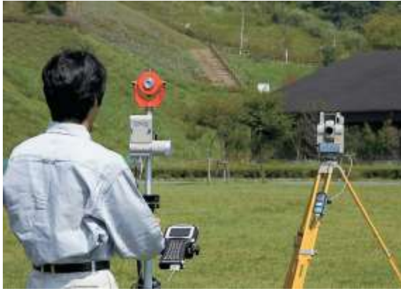
Pengukuran Arah Kiblat menggunakan Total Station
