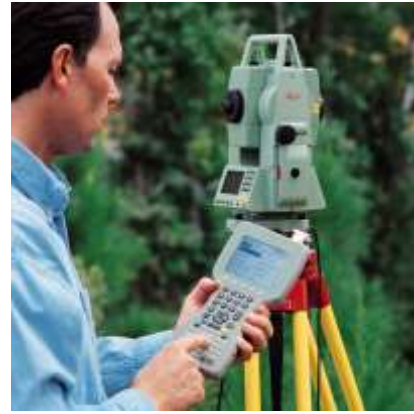
Pengukuran Arah Kiblat menggunakan Total Station
